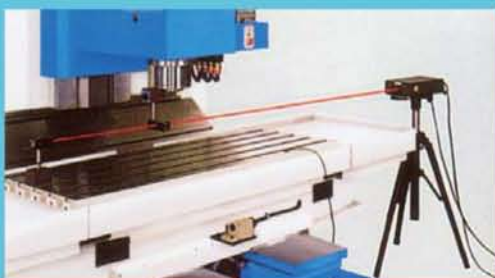
Controllo geometria tramite laser.
